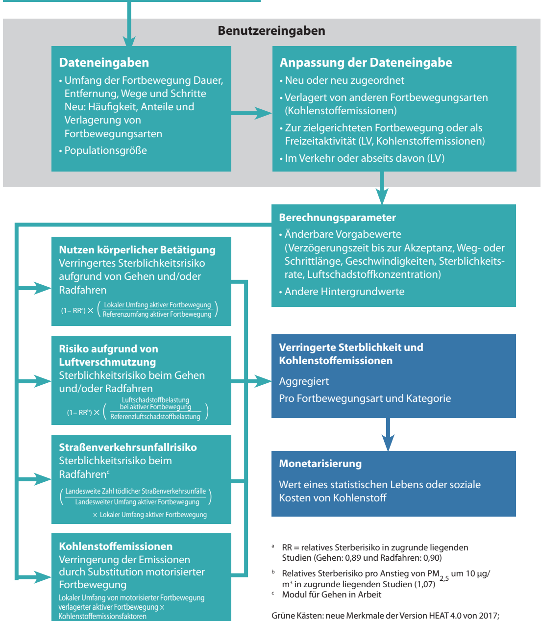
Abb. 2. Grundlegende Funktionsweise von HEAT
